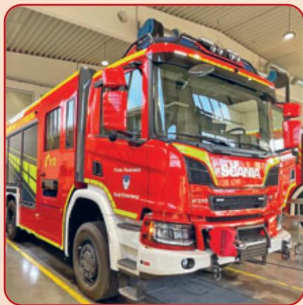
Das HLF 20 führt für die Brandbekämpfung eine fest eingebaute Feuerlöschkreiselpumpe mit einer Leistung von 3000 l/min mit, einen eingebauten Löschwassertank mit einem Inhalt von 2000 Litern, einen fest eingebauten Schaummittel-tank mit einem Fassungsvermögen von 120 l sowie die üblichen Geräte zur Wasserabgabe und Brandbekämpfung.
